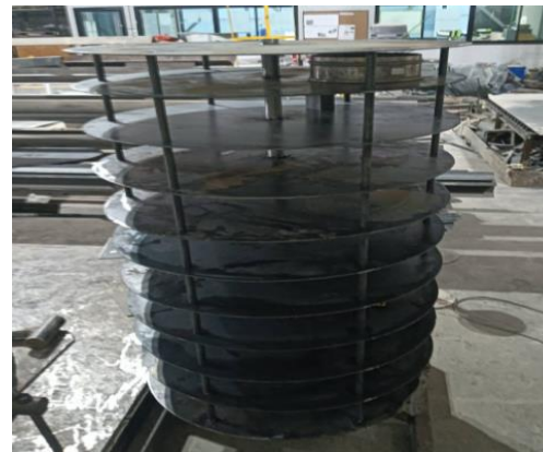
งานสร้างชิ้นวางตะแกรงร้อนตัวอย่าง
